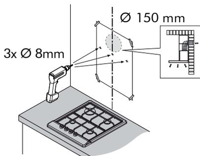
4. Instale as 3 buchas e os parafusos com diâmetro de 5 mm nos furos superiores, mantendo uma distância da parede à cabeça do parafuso de aproximadamente 5 mm.
