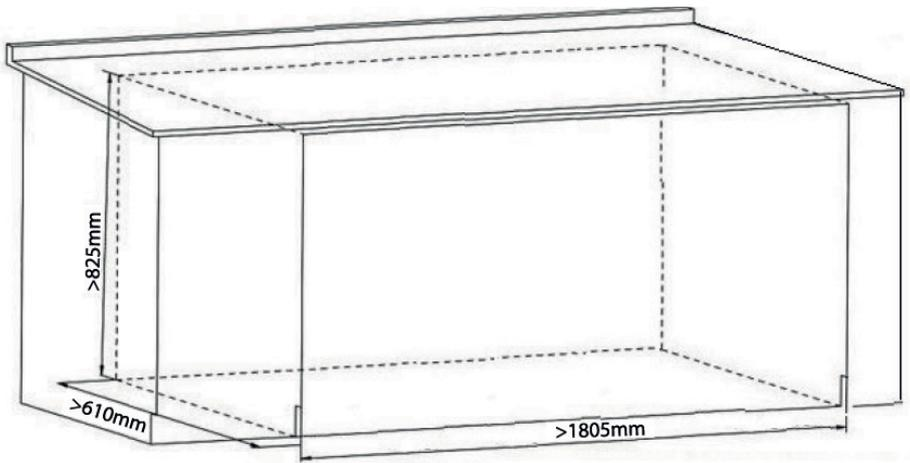
Para instalação próxima a uma parede, deixe um mínimo de (200 mm) do lado da parede para abrir a porta e movimentar as gavetas internas. Recomenda-se não instalar os aparelhos perto de uma fonte de calor, como um forno ou fogão.
