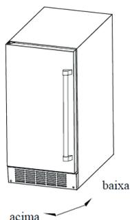
É importante para o perfeito funcionamento da máquina de gelo que o seu nivelamento esteja correto. Caso contrário, a água não vai fluir adequadamente através do molde de gelo e a produção de gelo será menor do que o normal, além disso, o desnivelamento pode causar barulhos anormais de funcionamento.
