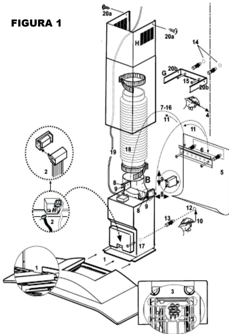
1. Regule a extensão da estrutura do suporte da coifa. Esta regulagem determina a distância que a coifa terá do plano de cozimento. A coifa deve ter uma distância de pelo menos 50cm no caso de fogões elétricos e de 75cm em caso de fogões à gás ou mistos.
